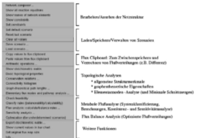
Abb. 4.5: Menüfunktionen im *FluxAnalyzer*
