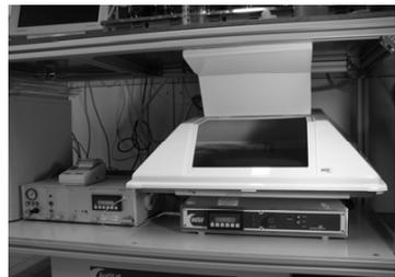
**Abbildung 2.-11: (links) Rührreaktor (5 L Arbeitsvolumen) mit Peripherie und (rechts) Wave® Bioreaktor 20 SPS (1 - 10 L Arbeitsvolumen) zur Kultivierung tierischer Zellen**
