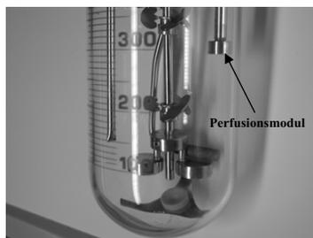
Abbildung 3.-5: (links) Aufbau der Perfusion im Rührreaktor und (rechts) an den Rührreaktor adaptiertes Perfusionsmodul
